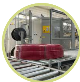
Estrusione di tubazioni in PE-RT
