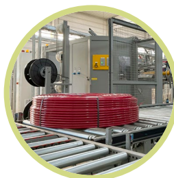
Estrusione di tubazioni in PE-RT
